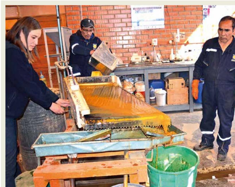
Laboratorio de Concentración en mesa, proceso en base a los pesos específicos de los minerales.
