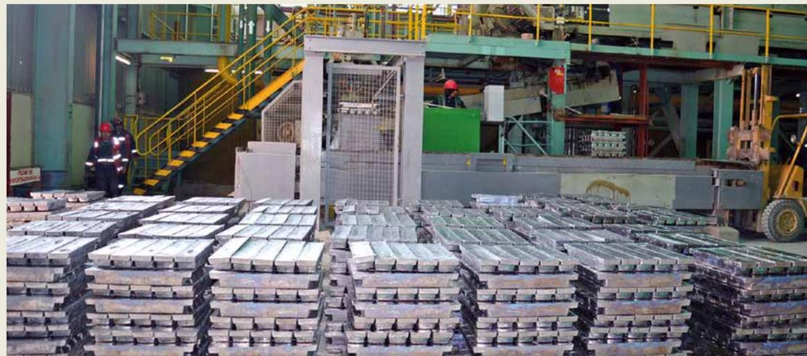
Producto del lingoteo del plomo 99,98% de pureza.
