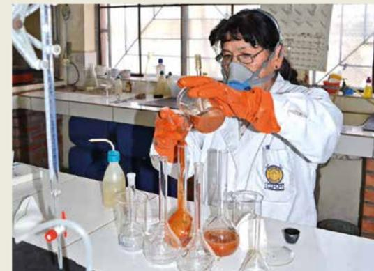
Precipitación para determinar el nivel de humedad de la muestra solicitada.
