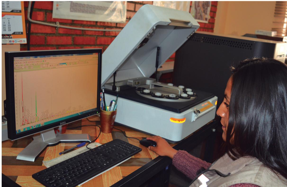
Área de Geología, espectrómetro de Fluorescencia de Rayos X donde se hacen análisis de fluorescencia de rayos x, método no destructivo.
