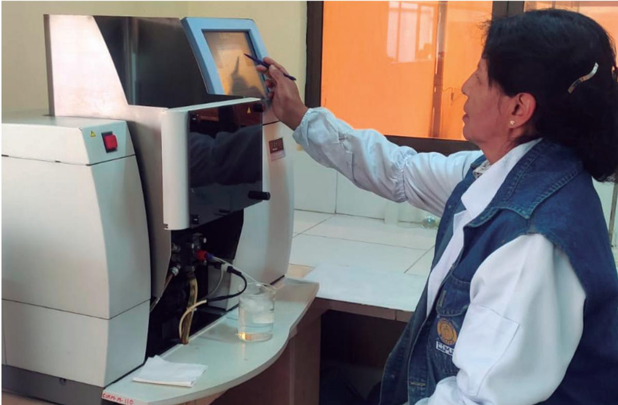
Laboratorio Instrumental de Química, equipo que realiza el análisis por Espectrometría de Absorción Atómica
