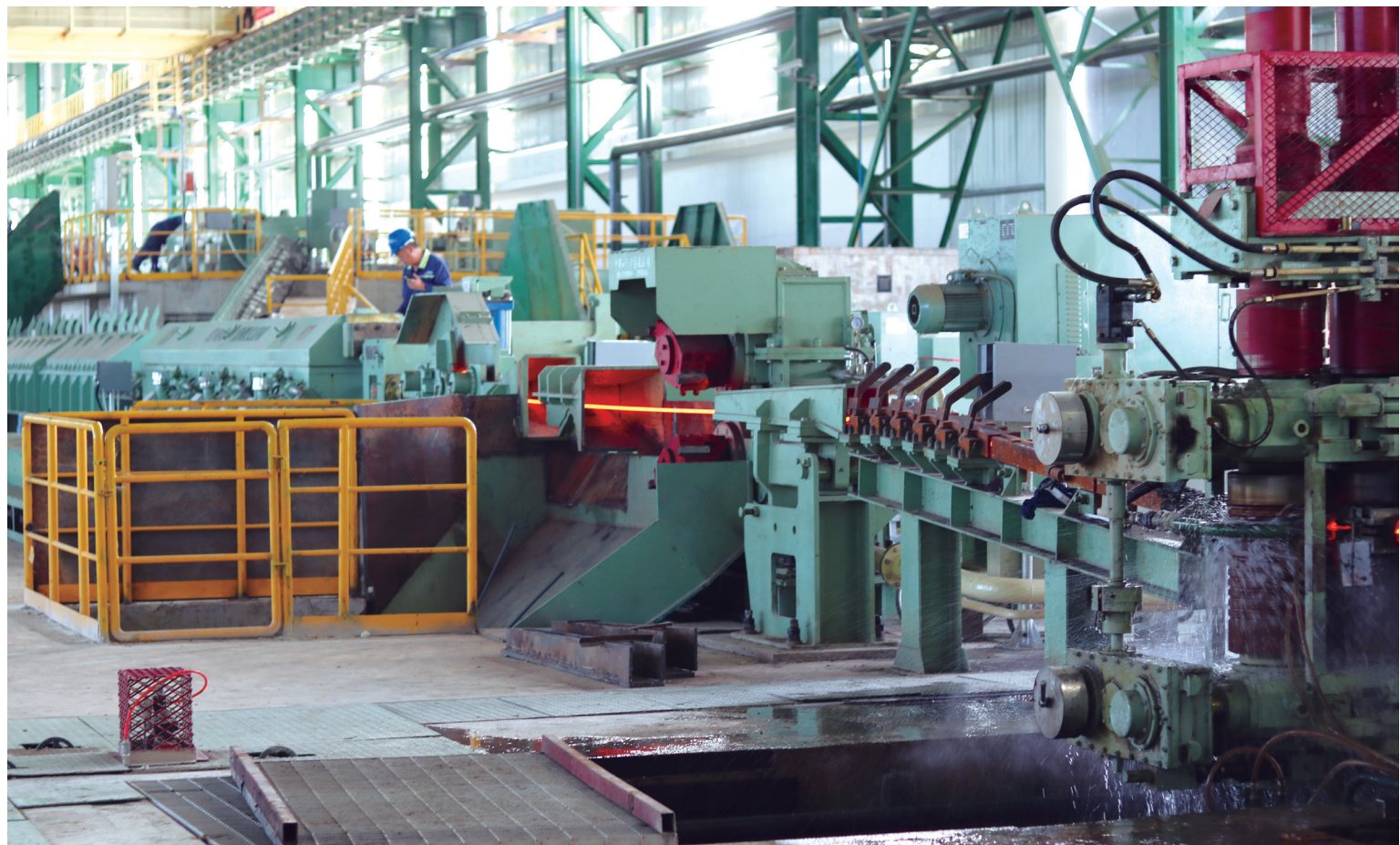
En la imagen la fabricación de fierro corrugado en el Complejo Siderúrgico del Mutún..
