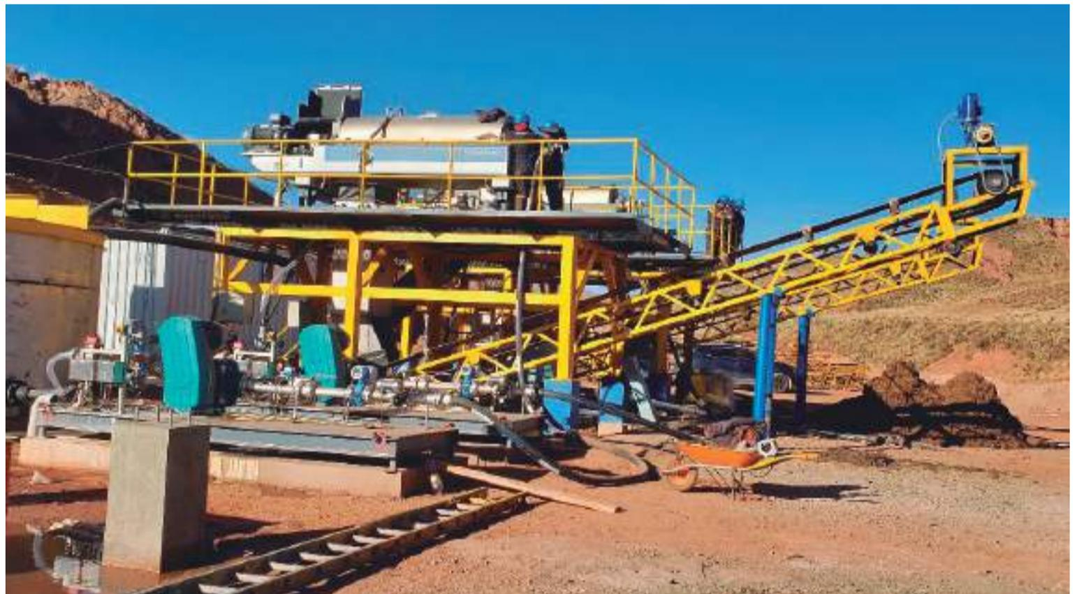
En la imagen el Decantador Centrífugo y Separador de Líquidos que permite una mejor explotación de cobre a la Empresa Minera Corocoro.
