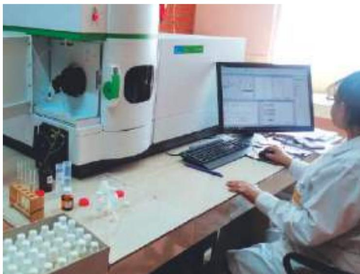
Análisis en el espectrofotómetro de emisión óptica con plasma acoplado inductivamente.
