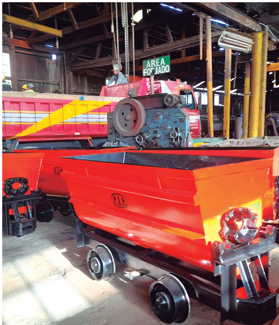
Carros metaleros fabricados en la Planta Industrial de Pulacayo listos para su entrega
