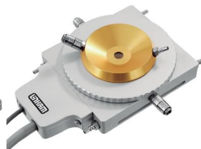
Platina Linkam con controles temperatura y ambiente de hasta 1500 oC.
