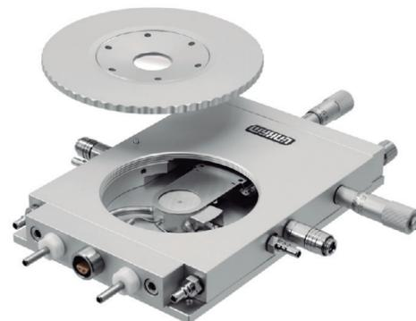
Platina Linkam con control de temperatura y ambiente de 195 oC a 600 oC.
