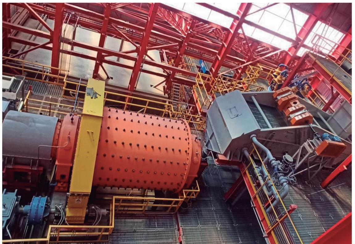
En la imagen una sección de la planta en la que se tritura la piedra para el procesamiento del mineral.
